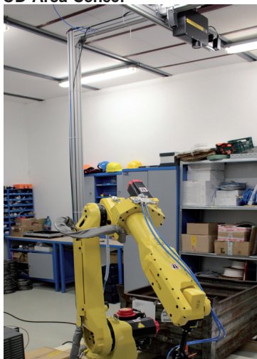
Robot po uložení kusu na paletu a 3D Area Sensor
