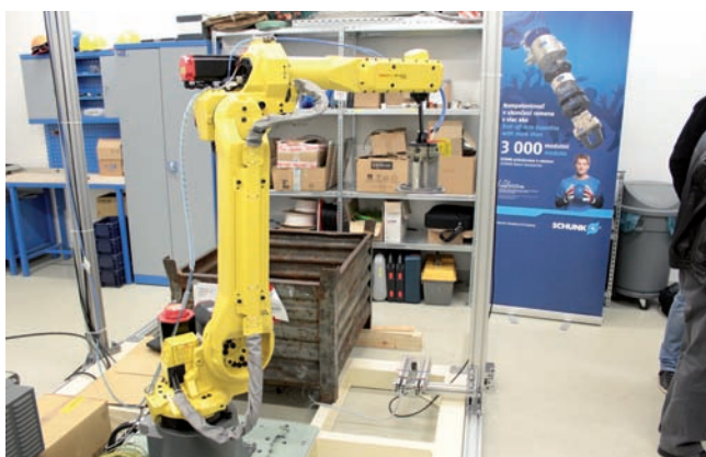
Vyhodnotenie uhla natočenia dielu pomocou dodatočného kamerového systému
