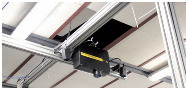
FANUC 3D Area Sensor – v strede je umiestnený laserový projektor, po bokoch dve kamery, systém je upevnený na konštrukcii z hliníkových profilov tak, aby do záberu kamier vošiel celý prepravný kôš
